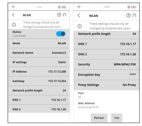
Figure 7-37: WLAN Mode
